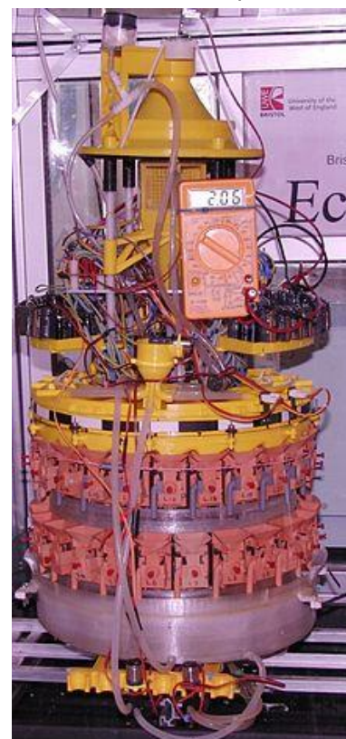
Afbeelding 2. Autonome robot gebaseerd op de EcoBot III biobrandstofcellen (Bron:
